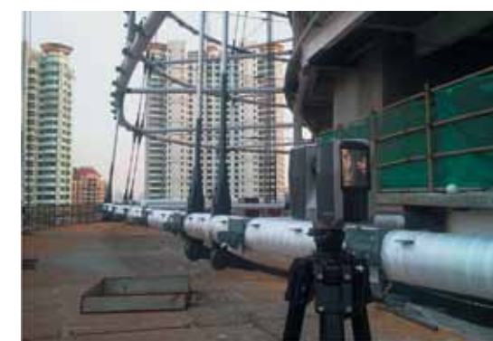
Мониторинг стройплощадки при помощи лазерного 3D-сканирования и информационного моделирования
