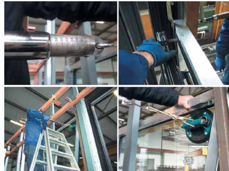
Структурное испытание стеклопакета на нагрузку в заводской лаборатории изготовителя
