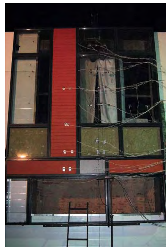
Вверху. Огневые испытания навесных панелей объекта на ул. С. Макеева, Москва Внизу. Монтаж панелей для жилого комплекса на ул. Пырьева, Москва
