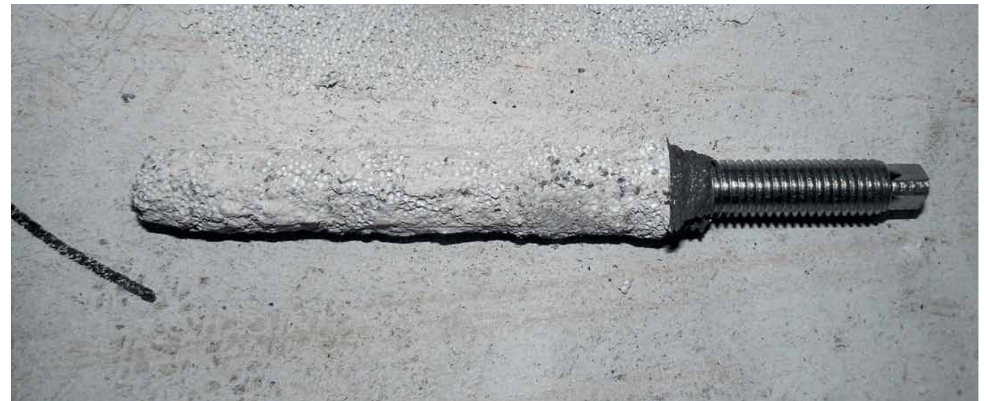
Рис. 5. Характер разрушения анкерного узла при вырыве
