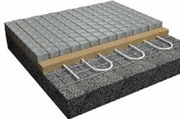
Пример укладки Uponor Meltaway под плитку
