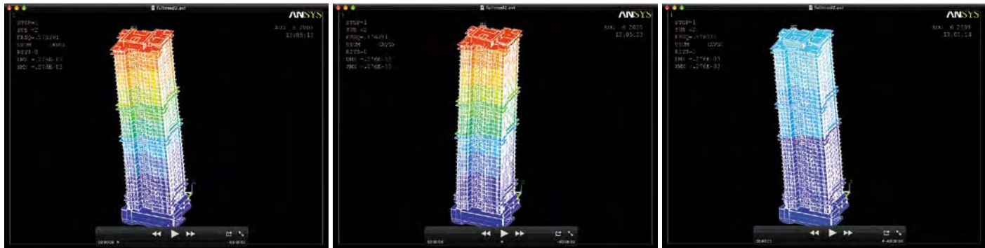
Рис. 18. Вторая форма колебаний на частоте 0,57 Гц
