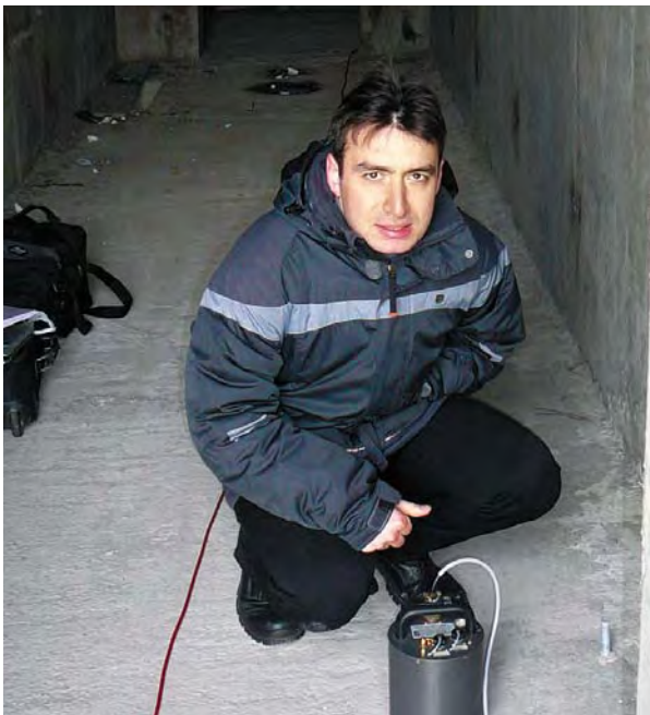
Рис. 3. Проведение замеров колебания объекта велосиметром CM-3 и акселерометром GURALP
