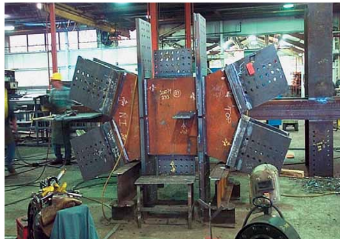
Рис. 10. Диагонально-сетчатые элементы (Diagrid) после сборки для использования в конструкции Swiss Re
