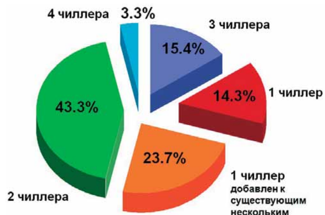
Рис. 2. Количество чиллеров в хладоцентрах: в 85% случаев установлено несколько чиллеров
