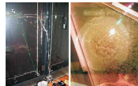
Рис. 11а. Лабораторные испытания двухслойной фасадной конструкции с широкой (1500 мм) буферной зоной в климатической камере НИИСФ РААСН
