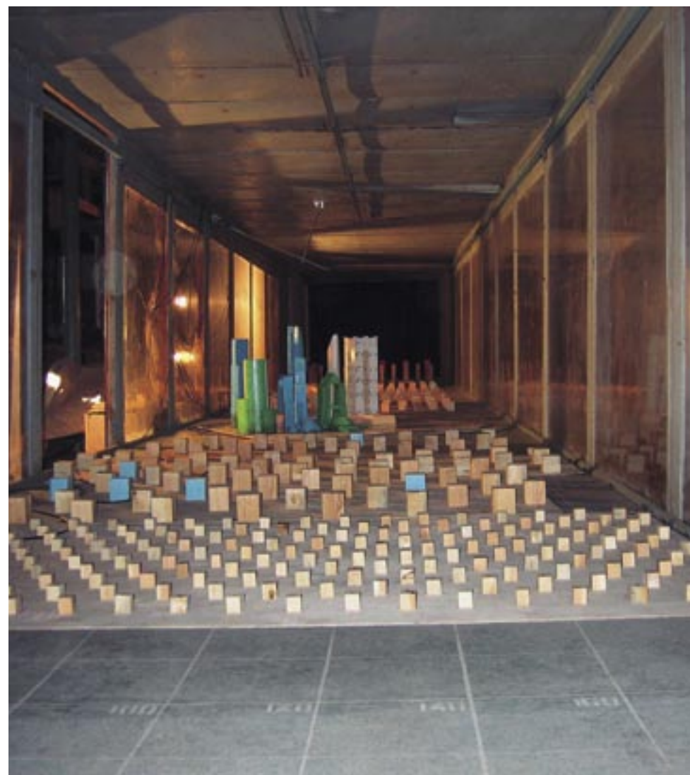
Рис. 5. Модели зданий в аэродинамической трубе УНИКОН
