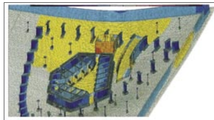
Рис. 6. Деформированная схема фрагмента фундаментной плиты с колоннами и стенами ядра жесткости башни «А» высотного комплекса
