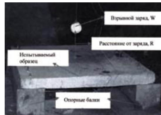
Рис. 5. Лабораторные испытания плиты на взрывную нагрузку
