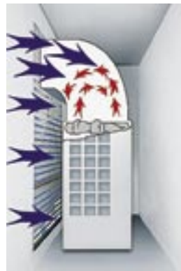
Рис. 3. Воздействие потока снаружи здания на работу системы кондиционирования
