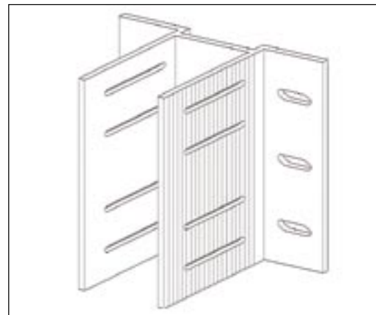
Рис. 3. Усиленный кронштейн системы U-kon HIGH
