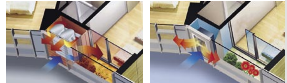
Рис. 1. Направление воздушного потока в наружном блоке системы MULTI V Space
