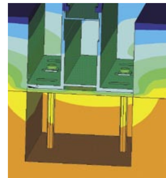
Рис. 9. Температурное поле несущего кронштейна АД-134 системы ATC 102i H с терморазрывной прокладкой «ТермоСтоп»
