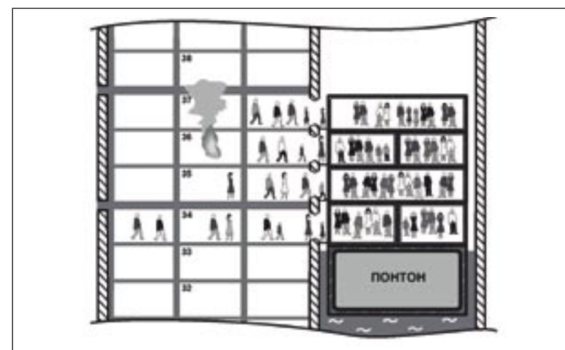
Рис. 6. Эвакуация людей из опасных зон при пожаре в плавающий лифт
