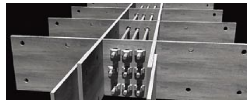
Рис. 7. Устройство скрытого каркаса – первый этап устройства перекрытий
