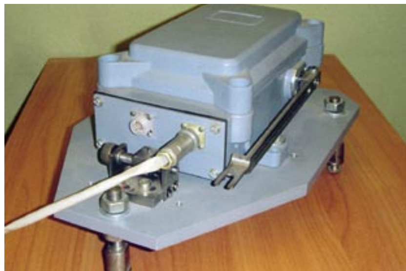
Рис. 4. Блок стационарного варианта системы мониторинга с монтажной платой и со съемными юстировочными устройствами
