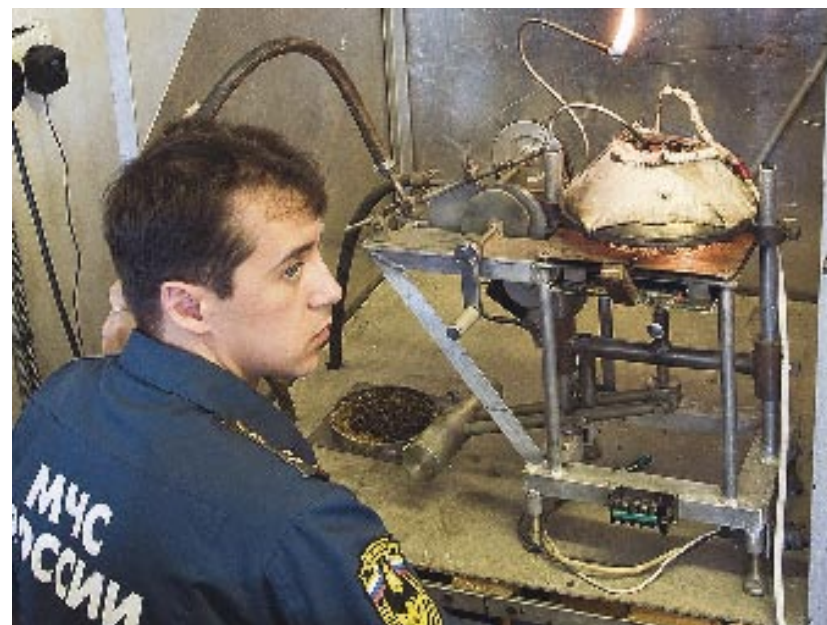
В компании КРАСПАН осуществляется входной контроль сырья, которое поставляется производителями гранул для сердечника алюминиевых композитных панелей Краспан-AL. Качество наполнителя контролируется в лаборатории ВНИИПО МЧС России.
