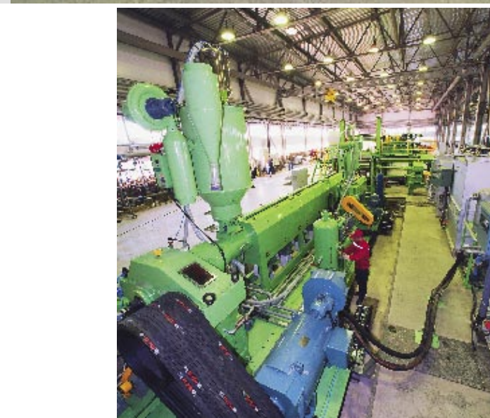
Завод КРАСПАН. Высокотехнологичная линия по производству огнестойких АКП Краспан-AL. Сердечник огнестойкой фасадной панели Краспан-AL на 75% (в перспективе – до 85%) состоит из минералов – этого позволяет добиться мощный экструдер новой линии завода КРАСПАН, аналога которой нет в России.
