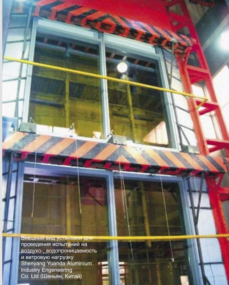
Испытательный центр Schüco Technology Center в г. Билефельде (Германия). Конструкция производства ООО ПКП «ВЭЛКО-2000» на испытательном стенде
