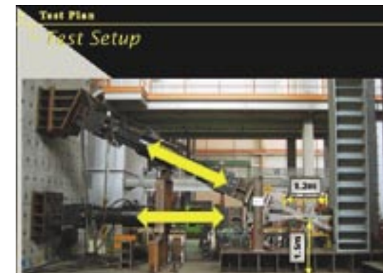
Рис. 3. Экспериментальная установка Слева направо, сверху вниз: Стена противодействия / Боковая опора / Приводной механизм / Опытный образец / Укрепленный пол
