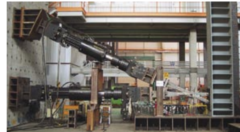
Рис. 3. Экспериментальная установка Слева направо, сверху вниз: Стена противодействия / Боковая опора / Приводной механизм / Опытный образец / Укрепленный пол
