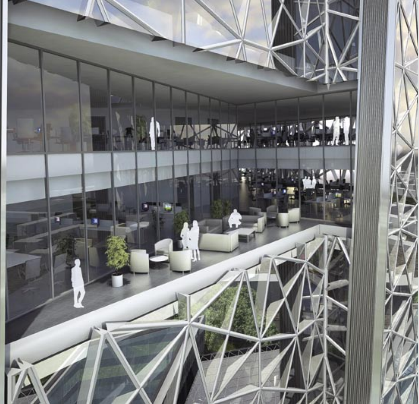
Буферная зона между двумя слоями остекления
