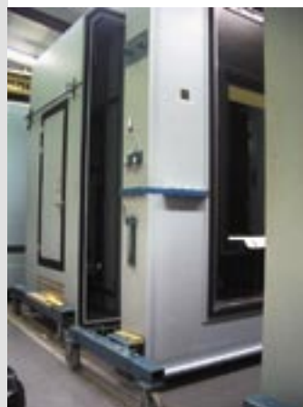
Климатическая камера (Hot box) в испытательном центре VTT, Финляндия
