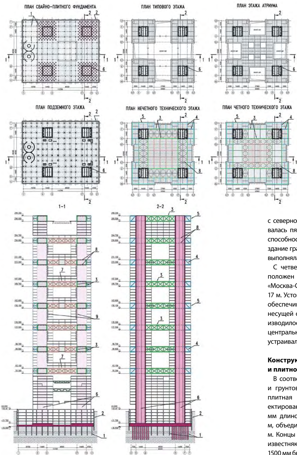
Рис. 1. КОНСТРУКТИВНАЯ СХЕМА ЗДАНИЯ НА УЧАСТКЕ № 15 ММДЦ «МОСКВА-СИТИ» (1-Я РЕДАКЦИЯ ПРОЕКТА)
