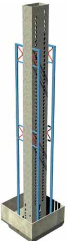
Рис. 42. One Rincon Hill South Tower: ядро-аутригерная система с выдерживающими продольный изгиб раскосами. ©MKA
