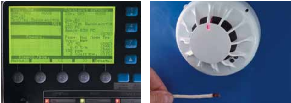
Рис. 1. Реакция на тлеющий фитиль извещателя 830PC: дым 6%/м (255 дискретов), концентрация CO 102 ppm (255 дискретов), температура 27 °C (086 дискретов)
