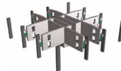
Рис. 74. Трехмерное изображение системы сопротивления сдвигу с амортизаторами (источник: Smith & Willford, 2008). © Arup
