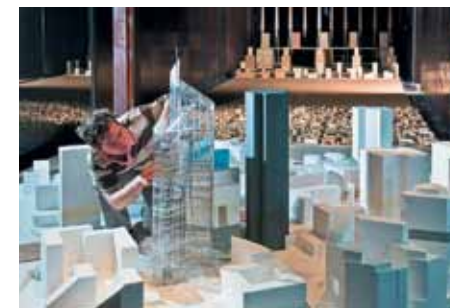
Аэродинамическая труба архитектурно-строительного типа (Scientific and Technical Centre for Building, Франция)
