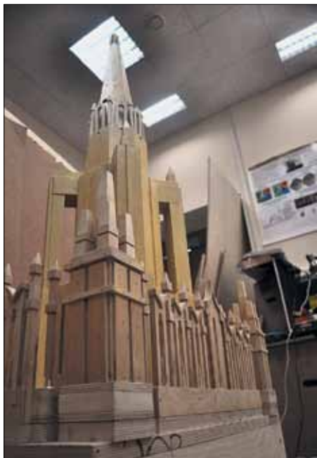
Результат численного моделирования и макет здания МИД для физических испытаний в БГАТ МГСУ
