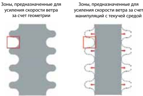
Рис. 5. Схематическое представление геометрических модификаций цилиндра (слева) и модификаций на основе текучей среды (справа). © CASE
