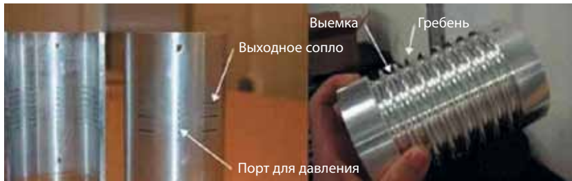
Рис. 6. Тело, спроектированное с применением подхода FAM с горизонтальными струйными соплами и портом для давления (слева) и GAM тела (справа). © CASE
