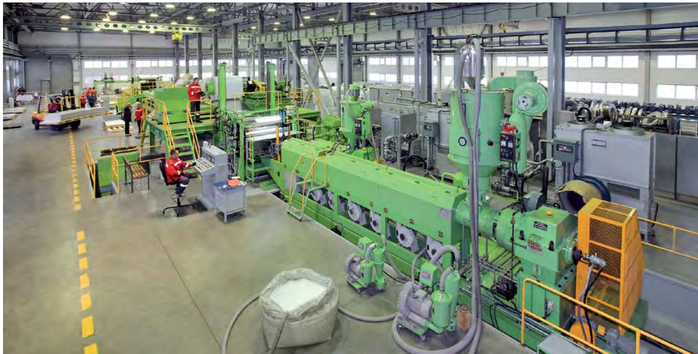
Завод «КРАСПАН». Единственная в России линия по выпуску огнестойких стальных композитных панелей
