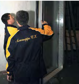
Стенд для испытаний на водо-, воздухопроницаемость и сопротивление ветровой нагрузке
