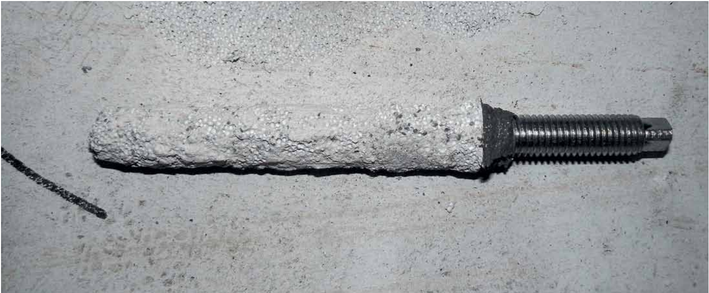
Рис. 5. Характер разрушения анкерного узла при вырыве
