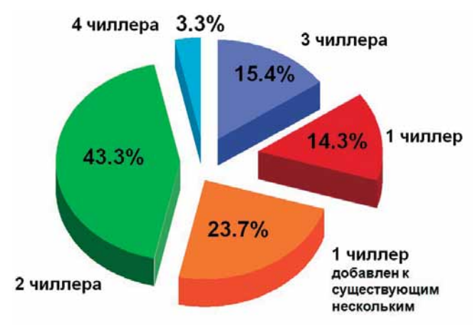
Рис. 2. Количество чиллеров в хладоцентрах: в 85% случаев установлено несколько чиллеров
