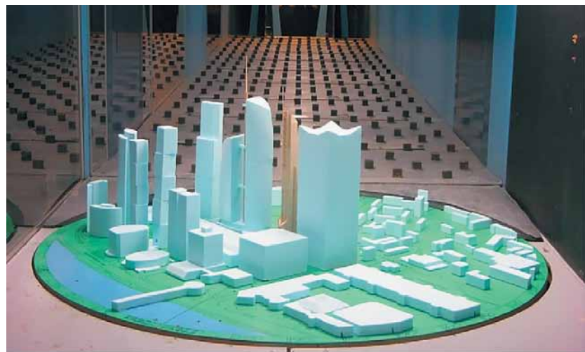
Рис. 8. Модели зданий «Москва-Сити» в аэродинамической трубе RWDI
