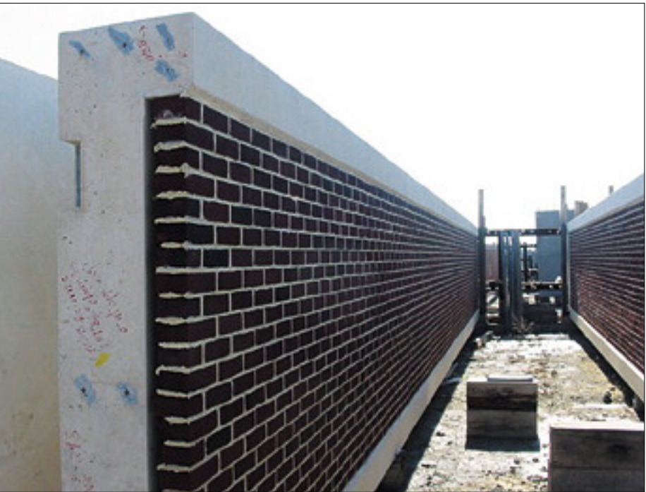
Рис. 2. Производство крупногабаритных железобетонных панелей «Great Wall» (Филадельфия, США)
