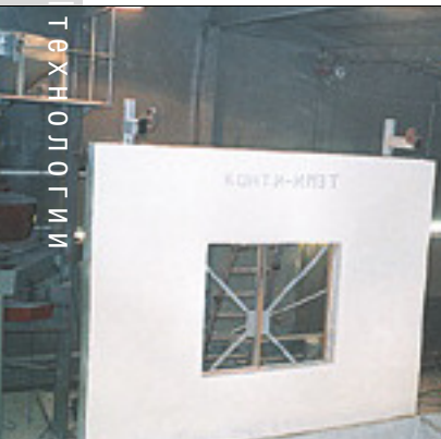
Рис. 3. Трехслойная теплоизоляционная навесная панель «Имэт»
