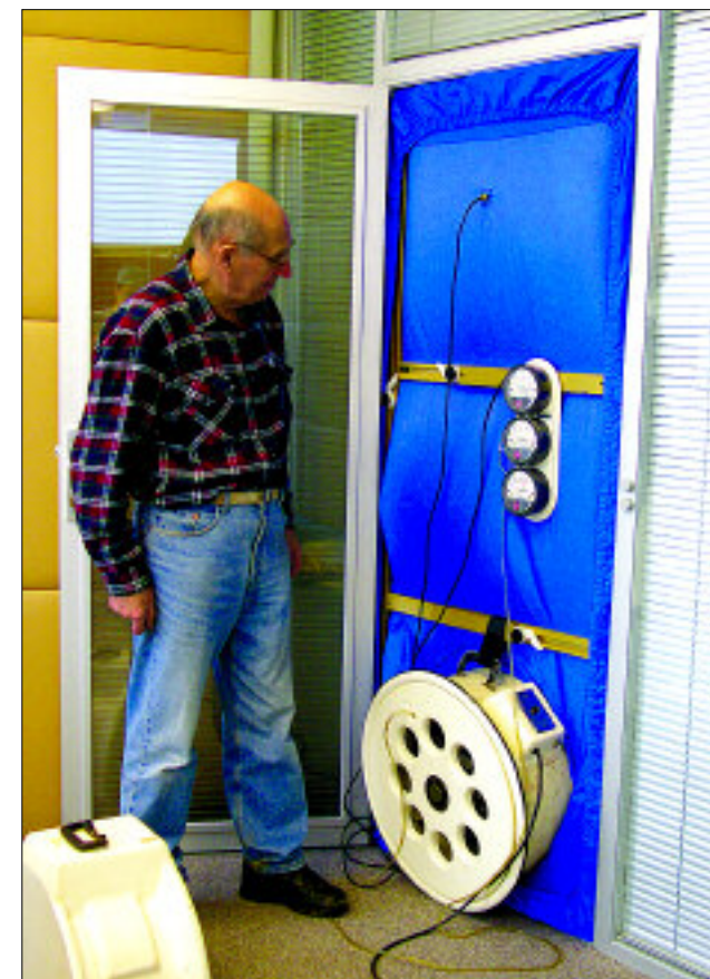
Испытание помещения на воздухопроницаемость
