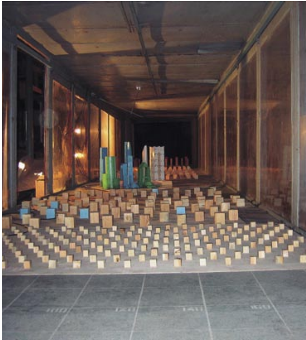
Рис. 5. Модели зданий в аэродинамической трубе УНИКОН
