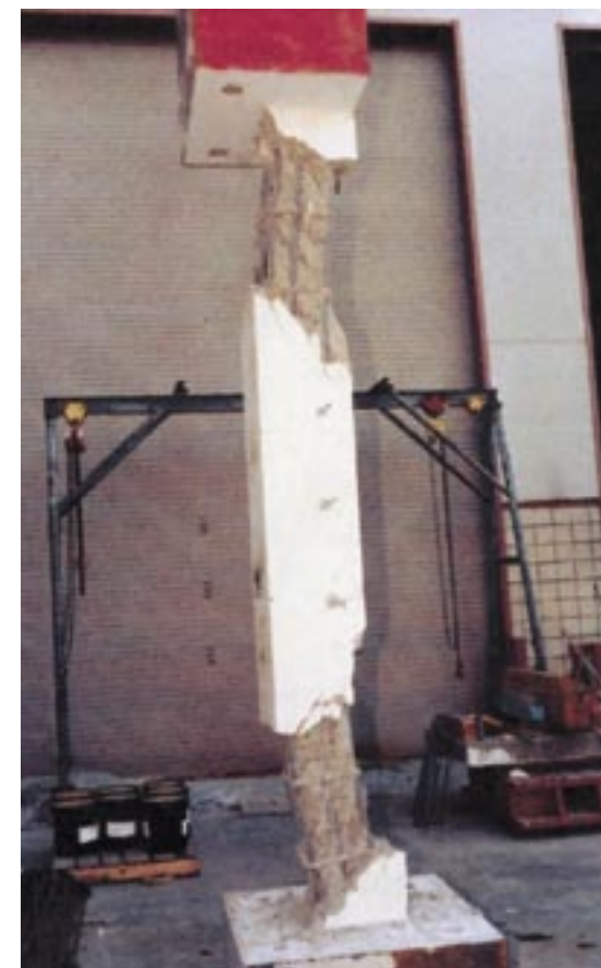
Рис. 3. Колонна без усиления после испытаний в лаборатории
