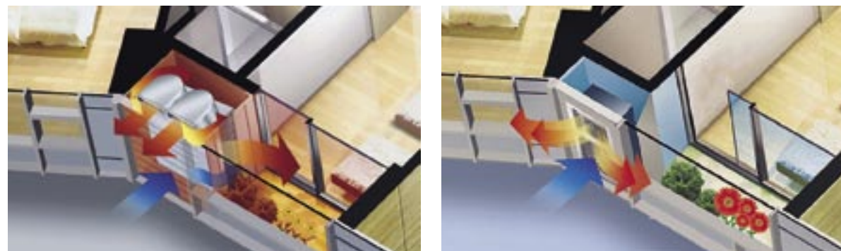
Рис. 1. Направление воздушного потока в наружном блоке системы MULTI V Space
