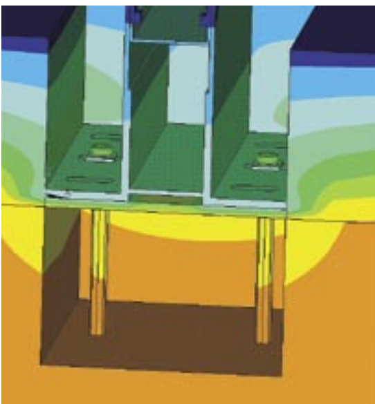
Рис. 9. Температурное поле несущего кронштейна АД-134 системы ATC 102i H с терморазрывной прокладкой «ТермоСтоп»
