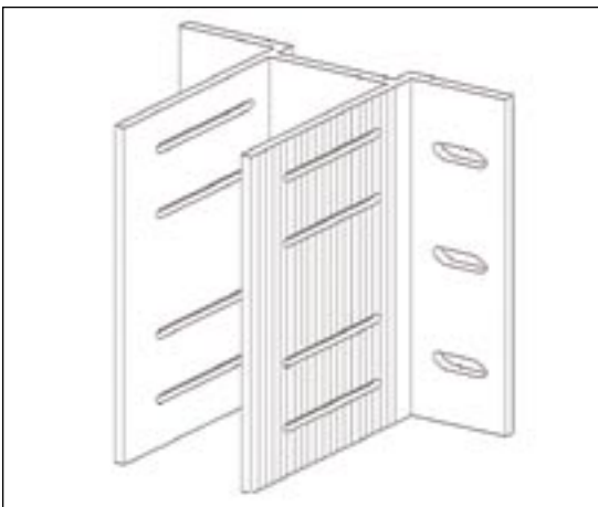
Рис. 3. Усиленный кронштейн системы U-kon HIGH
