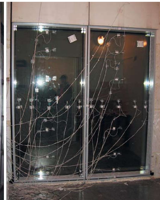
Испытание модулей ООО «Алютерра СК» в климатической камере
