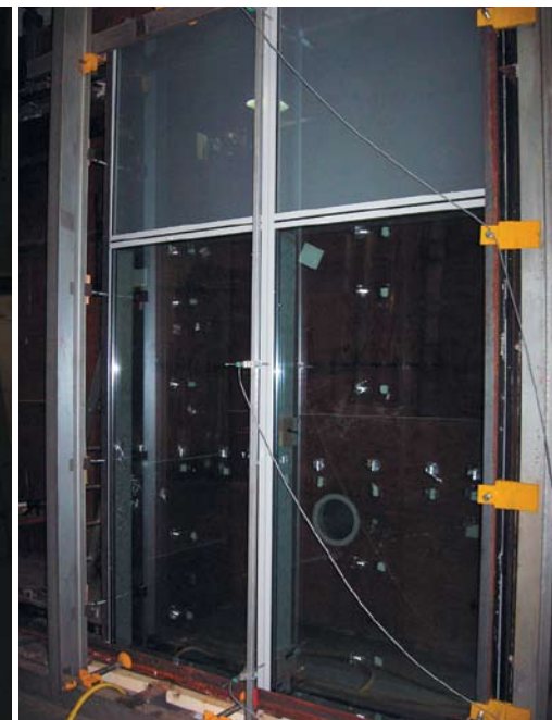
Стенд для испытаний на водо-, воздухопроницаемость и сопротивление ветровой нагрузке
