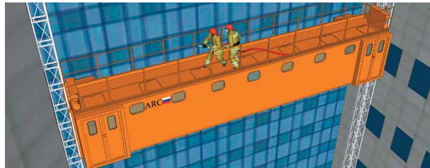
Модель двухмачтового подъемника, грузоподъемностью 8000 кг и вместимостью 100 человек
