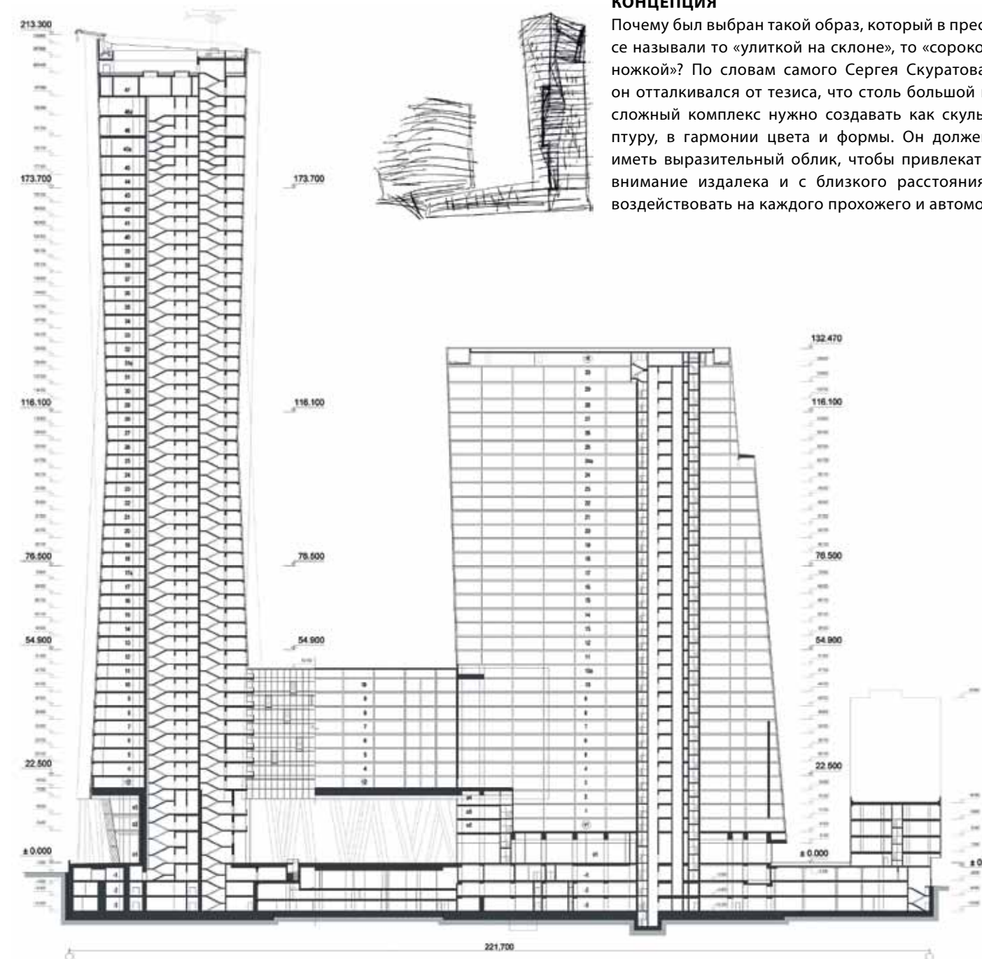
Вертикальный разрез башен и малоэтажной секции
