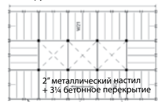
Жестко-сопряженные рамы, Рядовые поддерживающие балки
