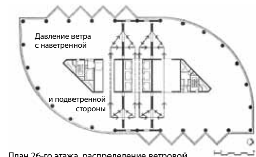
План 26-го этажа, распределение ветровой нагрузки по торцам перекрытия
